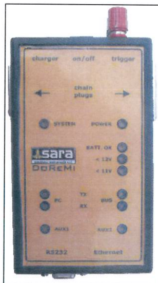
Sismografo DOREMI della Sara Electronic Instruments s.r.l.
