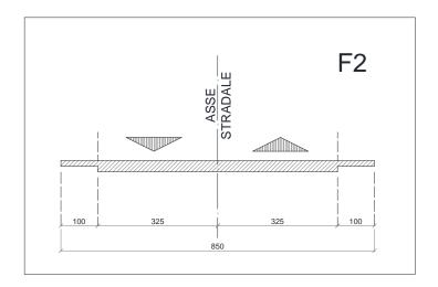
Due corsie da 3,25 m e 2 banchine da 1 m. In viadotto vengono aggiunti due cordoli laterali da 1m rialzati, per l'alloggiamento delle barriere di sicurezza, portando così la larghezza complessiva da 8,50m a 10,50m. Non è previsto dalle norme un marciapiede, non essendo in ambito urbano.
