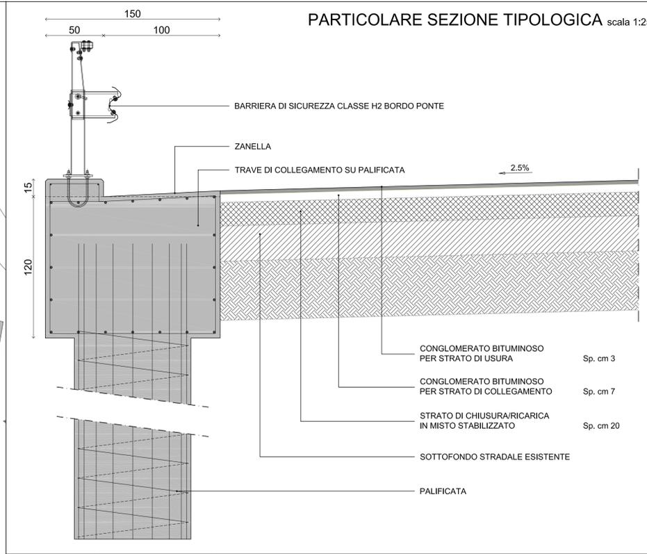
Realizzazione di una paratia in c.a. a valle della infrastruttura stradale, di lunghezza di circa m. 41.50 con zanella per il convogliamento delle acque meteoriche di piattaforma e sovrastante barriera di sicurezza stradale
