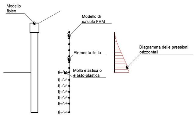
Figura 4: Schematizzazione della paratia ad elementi finiti
