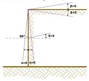
Figura 2: Convenzione utilizzata per il calcolo del coefficiente di pressione secondo la teoria di Caquot
