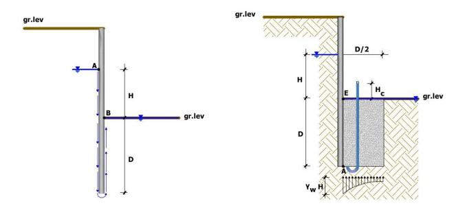
Per semplificare il problema della determinazione dell'effettivo andamento della pressione interstiziale nel punto A, si assume che il valore della sovrappressione al piede del diaframma sia costante sulla lunghezza D/2 e pari a  $\gamma_W x H_C$ . Per determinare  $H_C$  si ricorre all'espressione del gradiente di efflusso  $i_E$ :
